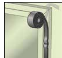
Stumpfstoß bei der Fenstermontage
