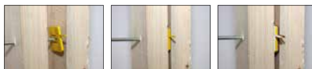
Fixierung an der Schraube durch Klemmbereich
