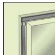
Eckauslage bei der Fenstermontage
