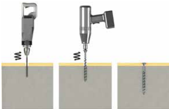
Montage mit Vorbohren
