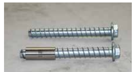
Hülse lässt sich komplett aufstecken, Schraube für Weiterverwendung nicht mehr geeignet
